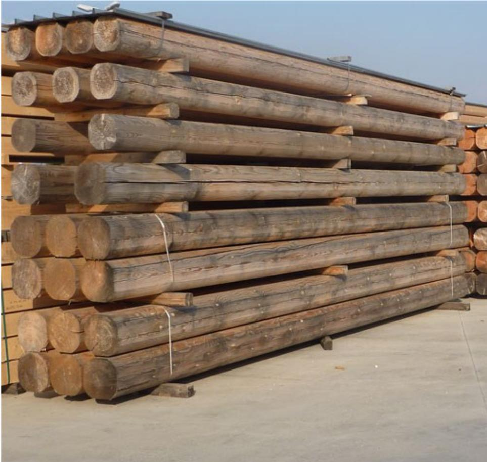
Per mantenere le sue caratteristiche, il legno necessita di un contatto diretto con l'aria.
